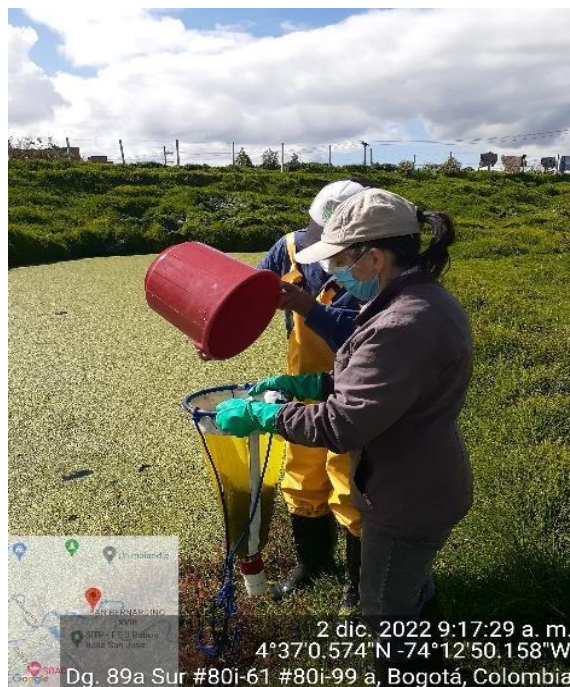
Figura 56. Filtrado de agua en el humedal del Chiguasuque – La Isla para la colecta de fitoplancton (malla de 17 \mu m) y zooplancton (malla de 60 \mu m). Fotografía tomada por: William López.
