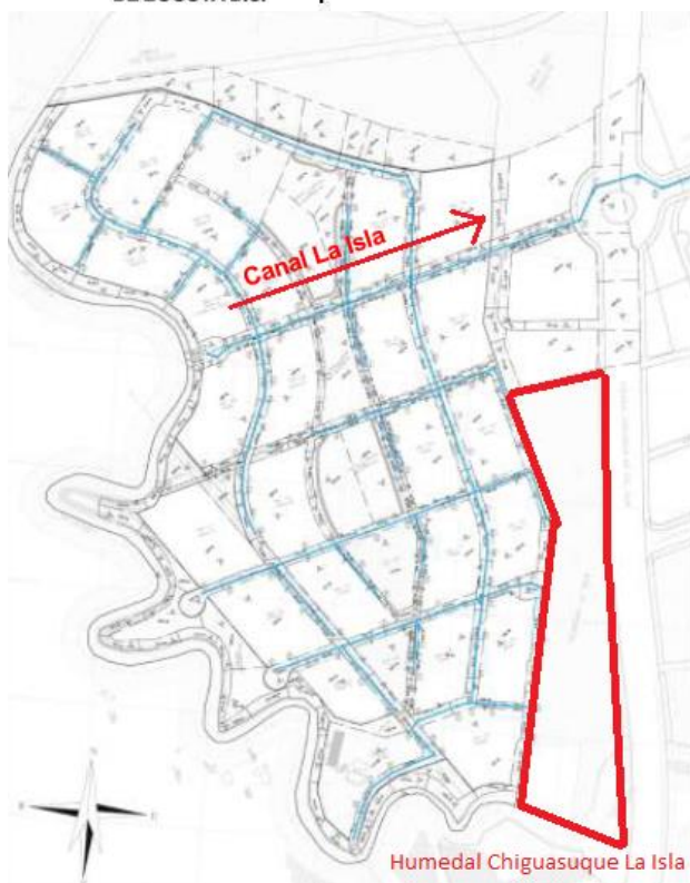
Figura 22. Propuesta área drenaje alcantarillado pluvial Plan parcial "La Marlene". Fuente: (Camilo Santamaria, 2021) a partir de (INERCO).
